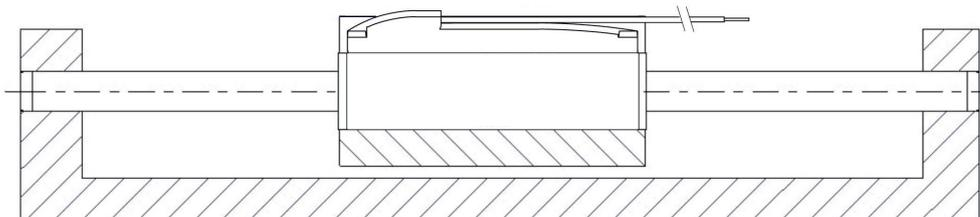
Verwenden Sie eine Kabelbefestigung, um das Ablösen des Steckers und/oder einen Anstieg der externen Kraft aufgrund des mechanischen Widerstands des Kabels zu vermeiden.
